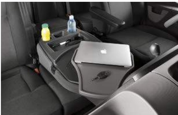
SOPORTE PARA ORDENADOR PORTÁTIL detrás del asiento abatible, con un compartimento, dos espacios para botellas y mesa pivotante.
