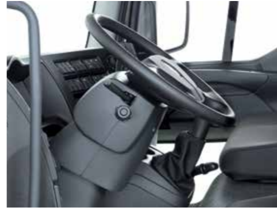
VOLANTE CON REGULACIÓN NEUMÁTICA en dos ejes.
