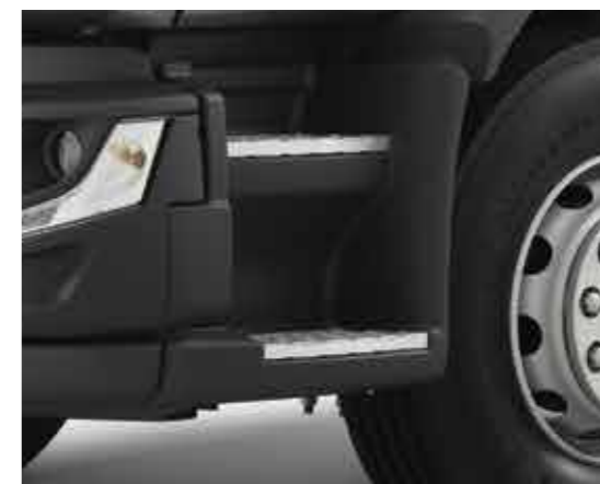
ESCALONES DE TIPO ESCALERA con el segundo peldaño 80 mm más para adentro para facilitar el acceso.
