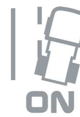
SISTEMA DE ADVERTENCIA DE CAMBIO INVOLUNTARIO DE CARRIL avisa con una señal acústica al conductor si detecta un desvío involuntario de la trayectoria del vehículo.
