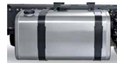
DEPÓSITO DE ALUMINIO con una capacidad de hasta 630 l de gasóleo y un 50 % más ligero que un depósito de acero.
