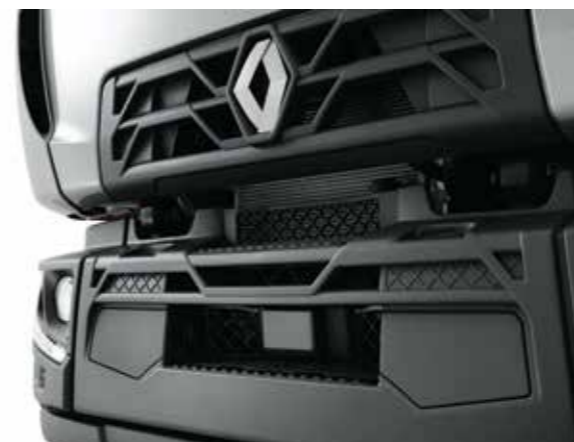
PELDAÑOS DE ACCESO AL PARABRISAS antideslizantes para facilitar la limpieza.
