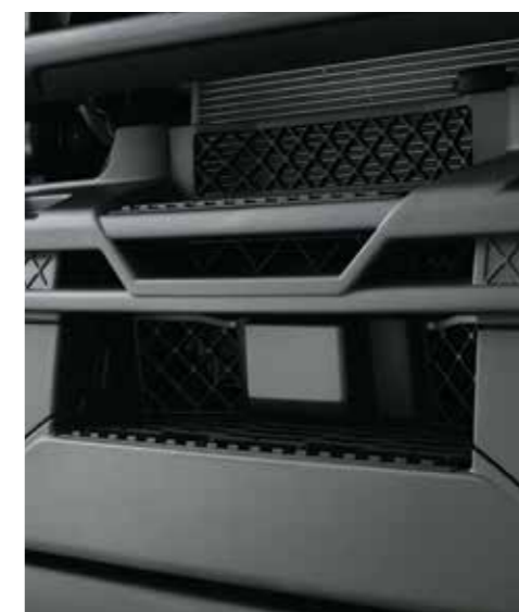
RADAR DE DETECCIÓN para el sistema de frenado de emergencia automático.
