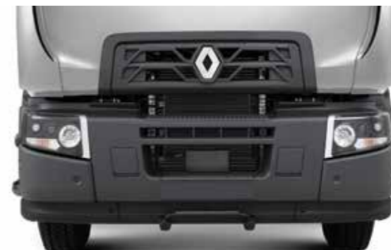
PARAGOLPES CON ESQUINAS DE ACERO (D WIDE) para ofrecer más resistencia.
