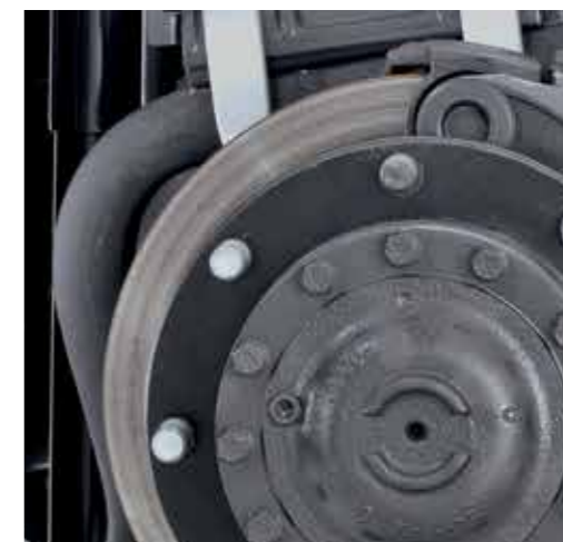
FRENOS DE DISCO permiten una deceleración de 7 m/s 2 en caso de frenado de emergencia (la normativa exige 4,5 m/s 2 ).
