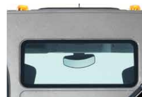
VENTANA TRASERA DE LA CABINA para facilitar el acceso para el mantenimiento del equipo (volquete, plataforma, etc.).
