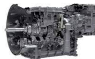
CAJAS DE CAMBIOS OPTIDRIVER Y OPTITRONIC permiten ahorrar un 7 % de combustible en comparación con una caja de cambios manual.
