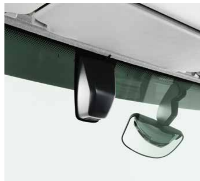
CÁMARA para el sistema de advertencia de cambio de carril y el frenado de emergencia automático.
