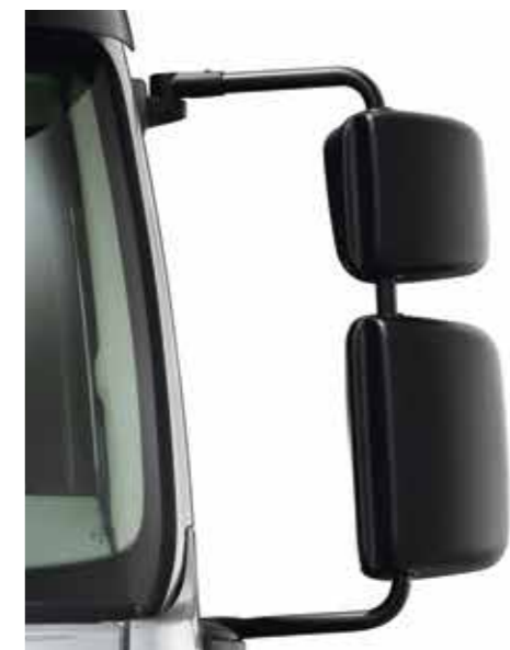
RETROVISORES adaptados a las distintas anchuras de cabina con soportes reforzados (menos vibraciones).
