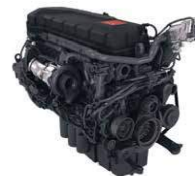
MOTOR DE 11 LITROS (DTI 11) HASTA 430 CV adaptado a las actividades del sector de la distribución y el transporte de vehículos.
