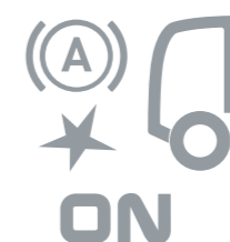
FRENADO DE EMERGENCIA AUTOMÁTICO avisa de una posible colisión y después frena y detiene totalmente el vehículo sin que intervenga el conductor.
