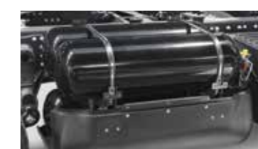
DEPÓSITO DE ACERO PARA GAS NATURAL con una capacidad de hasta 120 kg.
