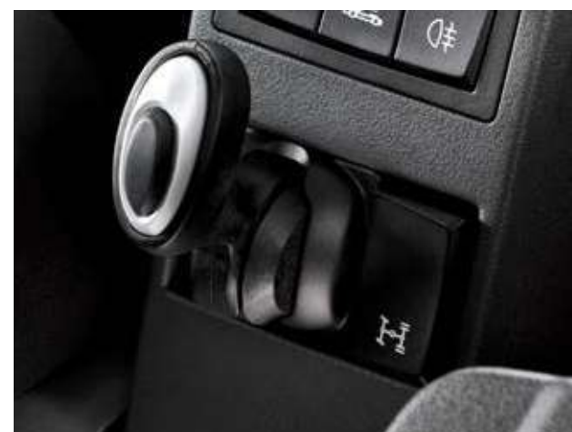
ACTIVACIÓN Y PARADA DEL SISTEMA EN EL SALPICADERO con la ayuda de un simple botón a una velocidad de entre 0 y 25 km/h.
