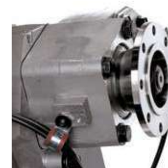
TOMA DE FUERZA para accionar el equipamiento de las carrocerías con el vehículo en circulación o parado.
