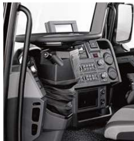
POSICIÓN DE SUBIDA/BAJADA DEL VEHÍCULO para facilitar el acceso al puesto de conducción.
