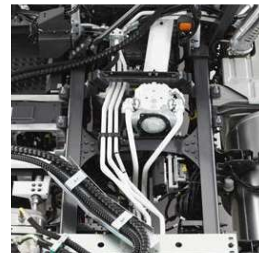
BOMBA HIDRÁULICA accionada por la toma trasera del motor.
