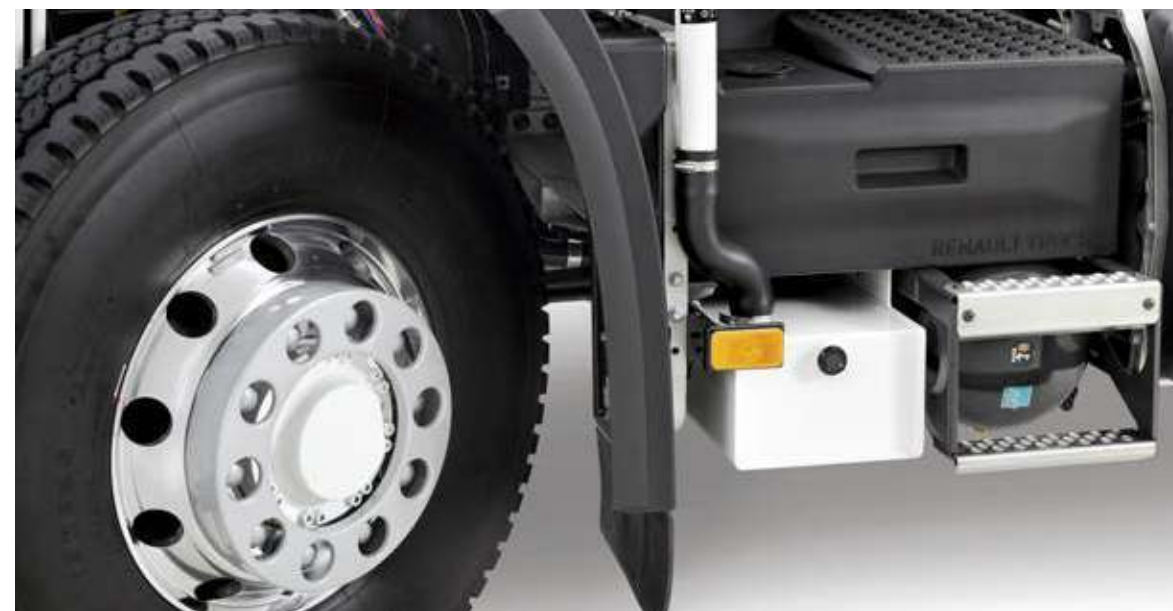
DEPÓSITO DE ACEITE INSTALADO EN LA CAJA DE LAS BATERÍAS para disponer de más espacio en el chasis
