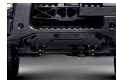
PANTALLA DE PROTECCIÓN en el radiador y la bandeja de aceite.
