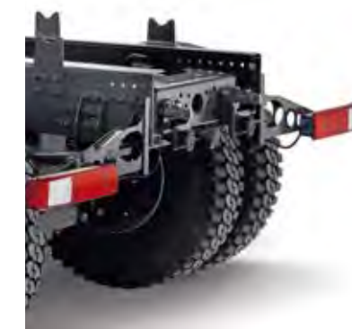
VOLADIZO TRASERO disponible por tramos de 50 mm para no tener que cortar los largueros.
