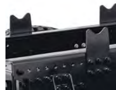
SOPORTES DE PLACAS EN LOS LARGUEROS para facilitar las operaciones de carrozado.
