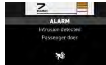
ALARMA ANTI-INTRUSIÓN avisa al conductor si se abren las puertas.
