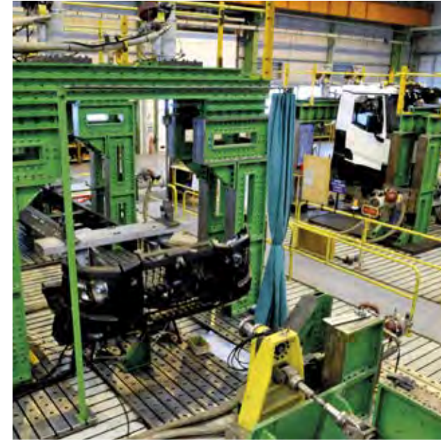
BANCOS DE VIBRACIONES con miles de horas de prueba para garantizar la fiabilidad de la cabina.
