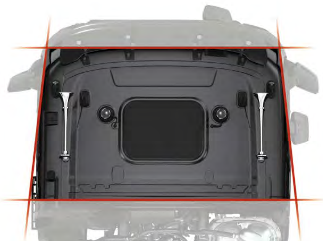
CABINA DE FORMA TRAPEZOIDAL para mejorar la penetración en el aire y la maniobrabilidad.
