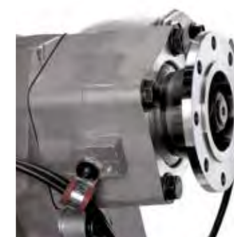
TOMA DE FUERZA para accionar el equipamiento de los carroceros con el vehículo en circulación o parado.
