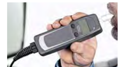
ALCOHOLÍMETRO CON BLOQUEO DEL ARRANQUE permite comprobar la tasa de alcoholemia del conductor antes de poner en marcha el vehículo.
