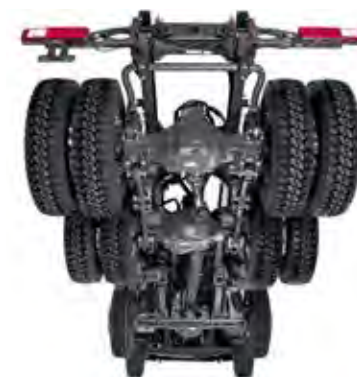
EJE MOTRIZ TÁNDEM DE REDUCCIÓN DOBLE para mejorar la tracción en terrenos difíciles.
