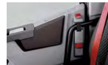
BLOQUEO MECÁNICO DE LAS PUERTAS permite un cierre adicional de las puertas desde el interior del vehículo.
