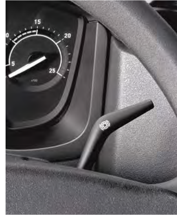
CONTROL DE LOS RALENTIZADORES Optibrake, Optibrake+ y Voith.
