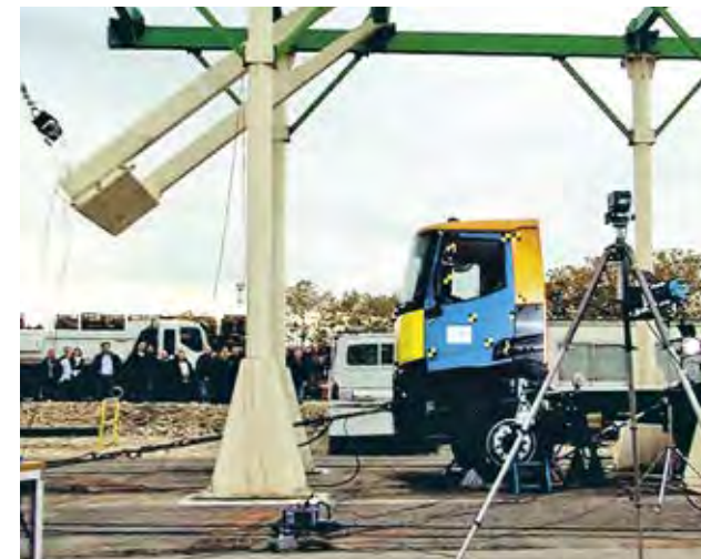
COLISIÓN FRONTAL para medir la resistencia de la cabina a las colisiones.
