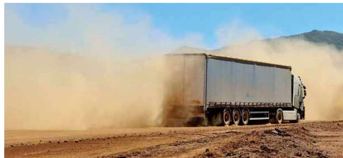
PRUEBA DE TEMPERATURAS EXTREMAS realizada en Almería, para medir la resistencia del vehículo en condiciones difíciles (polvo, calor, etc.).
