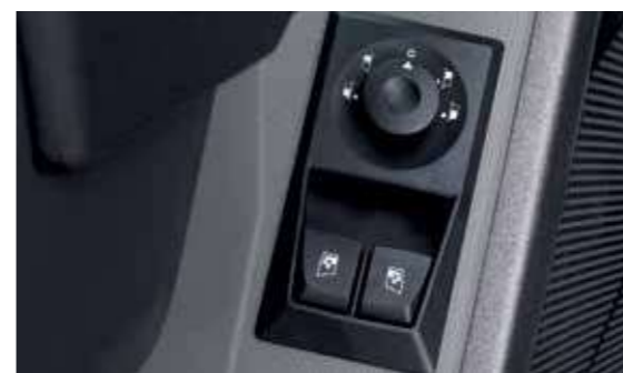
CRISTALES Y RETROVISORES LATERALES Elevación impulsional y regulación eléctrica de los retrovisores principales y gran angular.
