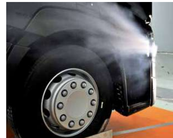
TÚNEL DEL VIENTO para medir la penetración de la cabina en el aire.
