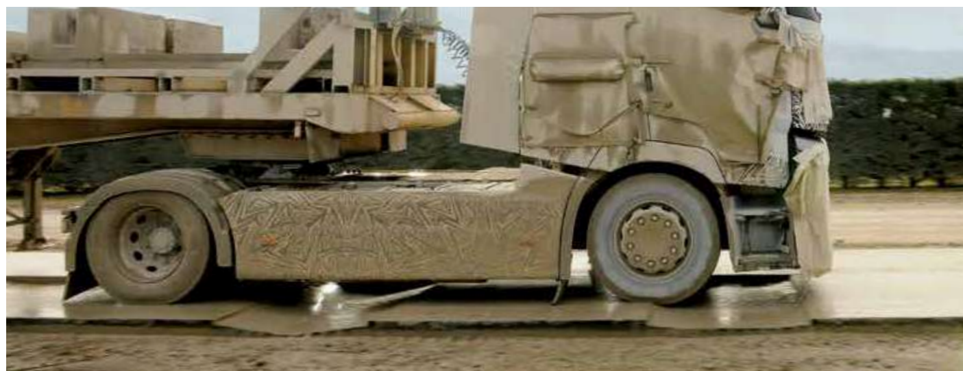
PRUEBA EN PISTA SEVERA para verificar la resistencia y la fiabilidad de las suspensiones.
