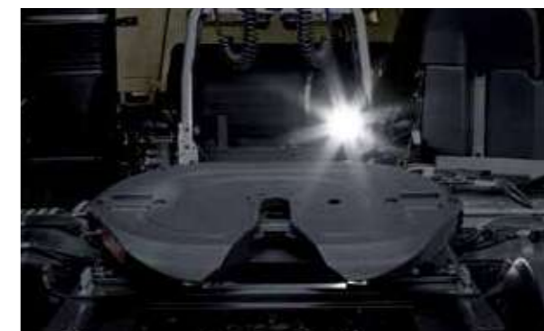
FOCO DE TRABAJO para iluminar la plataforma.
