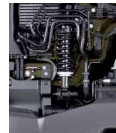
SUSPENSIONES DELANTERAS DE CABINA NEUMÁTICAS O MECÁNICAS adaptadas a aplicaciones exigentes para mejorar la estabilidad del vehículo.
