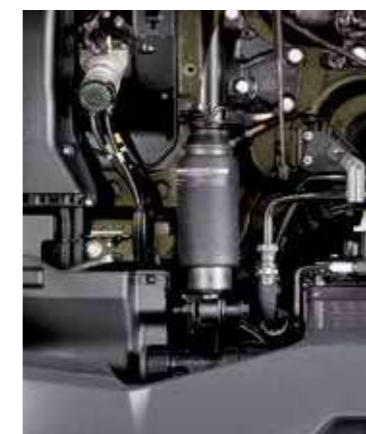
SUSPENSIONES DELANTERAS DE CABINA NEUMÁTICAS O MECÁNICAS adaptadas a aplicaciones exigentes para mejorar la estabilidad del vehículo.
