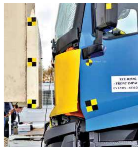
COLISIÓN FRONTAL para medir la resistencia de la cabina a las colisiones.
