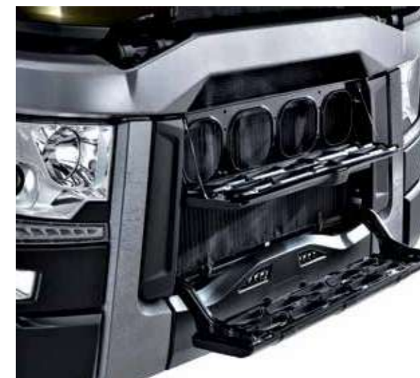
ACCESO AL PARABRISAS con dos auténticas plataformas para la limpieza del parabrisas.
