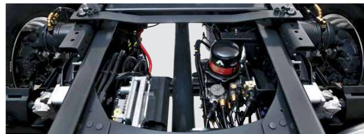
SEPARACIÓN DE LOS HACES ELÉCTRICOS Y NEUMÁTICOS para facilitar el mantenimiento.
