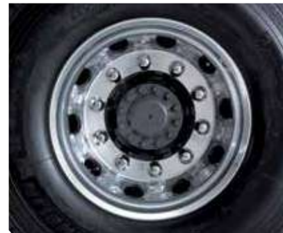
LLANTAS DE ALUMINIO para reducir el peso del vehículo hasta 200 kg.
