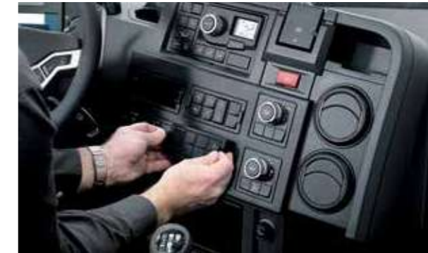
SE PUEDE MODIFICAR LA POSICIÓN DE LOS BOTONES para personalizar el puesto de conducción.
