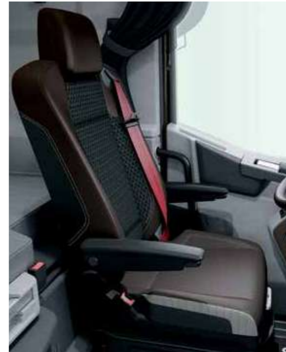
ASIENTOS CON SUSPENSIÓN Y CON CINTURONES DE SEGURIDAD INTEGRADOS Asientos térmicos y con ventilación, reposacabezas, apoyos lateral y lumbar regulables. Intervalo de regulación longitudinal de 20 cm para dejar más espacio para las piernas.
