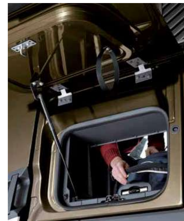
MALETERO INTERIOR/EXTERIOR para facilitar la carga de equipaje pesado.
