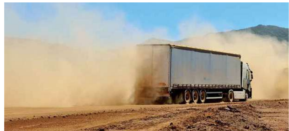
PRUEBA DE TEMPERATURAS EXTREMAS realizada en Almería, para medir la resistencia del vehículo en condiciones difíciles (polvo, calor, etc.).
