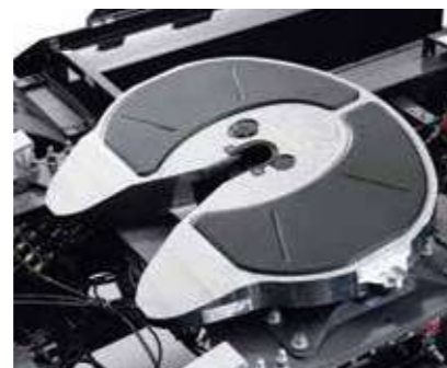
QUINTA RUEDA DE ALUMINIO reduciendo el peso del vehículo 22 kg.
