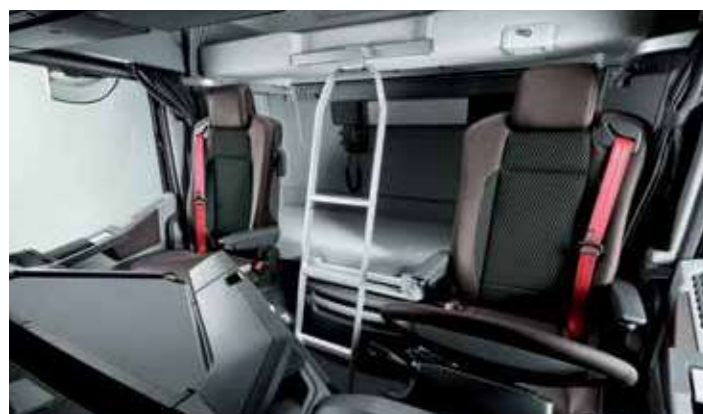
LITERA EXTENSIBLE DE 800 MM DE ANCHURA espuma de alta densidad (40 kg/m 3 ) y litera superior accesible mediante una escalera.
