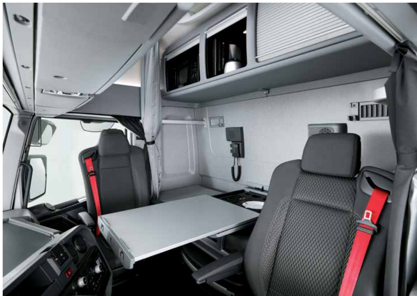
DISTRIBUCIÓN DE CABINA MAXISPACE con mesa retráctil y repisa suplementaria en la parte trasera de la cabina que consta de tres compartimentos portaobjetos.
