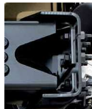
AMPLIA GAMA DE REFUERZOS DE LARGUEROS con espesor, altura y refuerzos modulares.
