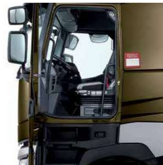
APERTURA DE LAS PUERTAS A 85° con descansillo para poder acceder a la cabina con total comodidad.
