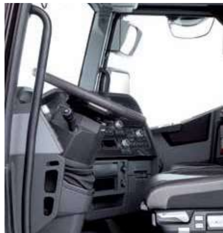
VOLANTE REGULABLE EN TRES DIMENSIONES altura, profundidad, inclinación.
