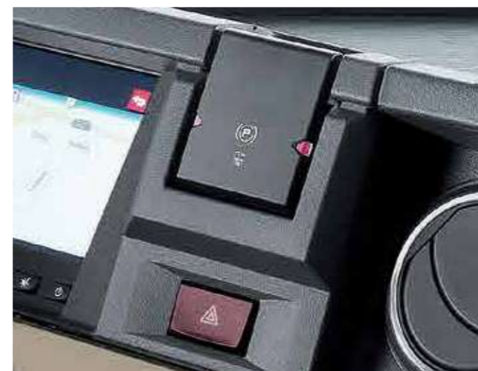
FRENO DE ESTACIONAMIENTO ELÉCTRICO AUTOMÁTICO AL PARAR EL MOTOR
