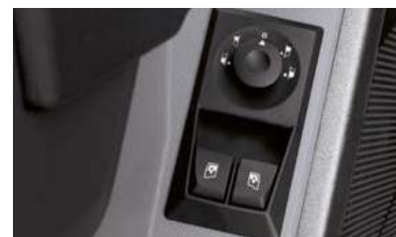
CRISTALES Y RETROVISORES LATERALES Elevalunas impulsional y regulación eléctrica de los retrovisores principales y gran angular.
