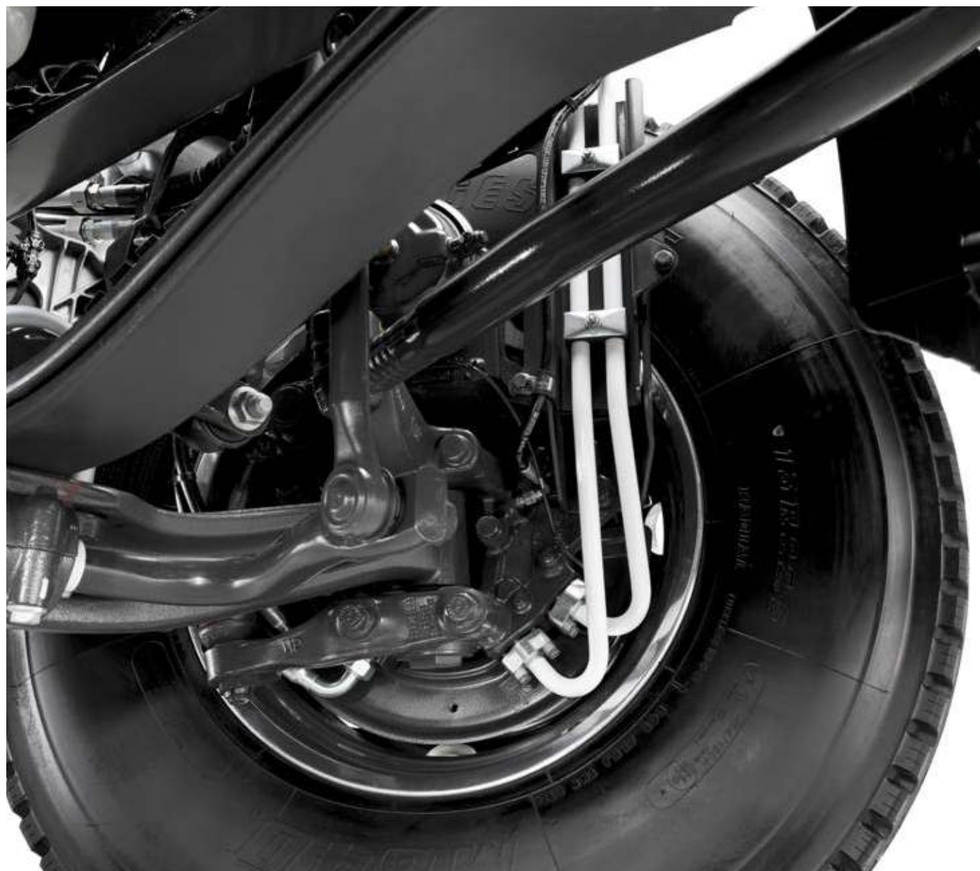
EJE DELANTERO EQUIPADO CON 2 MOTORES HIDRÁULICOS con una potencia unitaria de 41 kW.
